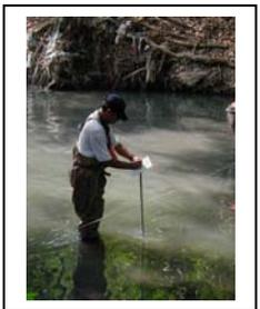
Se anotan los datos de profundidad y velocidad parcial de la sección transversal donde se realiza el aforo, para luego calcular los caudales parciales y su sumatoria representa el caudal total.
